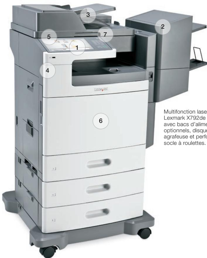
Multifonction laser couleur Lexmark X792de représenté avec bacs d'alimentation optionnels, disque dur, agrafeuse et perforateur et socle à roulettes.
