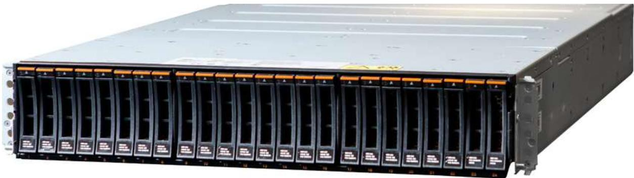
La seconde génération des Storwize V5000 dispose d'une connectivité interne en SAS 12 Gbit/s et dispose de ports Fibre Channel 16 Gbit/s et d'interfaces Ethernet 10Gigabit pour les liens vers les serveurs. Selon IBM, la plupart des déploiements de baies Storwize se fait en mode hybride avec en moyenne 5 à 10 % de la capacité fournie par des SSD et le solde par des disques SAS 7 200 tr/mn. Mais rien n'empêche un client d'opter pour des déploiements en 100 % Flash.
